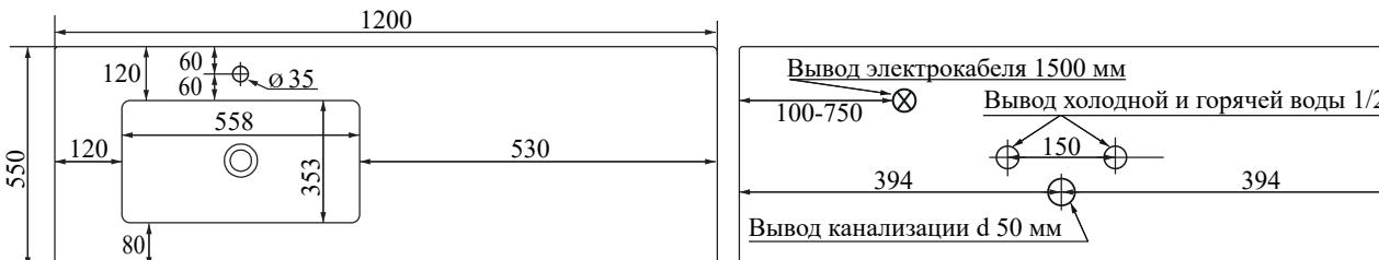
Вывод горячей и холодной воды, устанавливаются угловые шаровые краны
