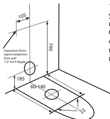
1. Установите чашу унитаза к выходу канализации. Сделайте отверстие для фиксирования скоб к полу и закрепите их.
