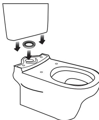
2. Установите резиновый уплотнитель в отверстие на унитазе (не используйте герметик). Поместите винты/втулки в отверстия на внутренней стороне бака. Аккуратно опустите сливной бачок на унитаз, таким образом, чтобы винты совпали с соответствующими отверстиями на унитазе и закрепите его.
