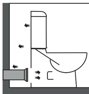
4. Выровняйте и придвиньте полностью собранный унитаз к стене, совмещая выход канализации с керамическим выпуском чаши унитаза.
